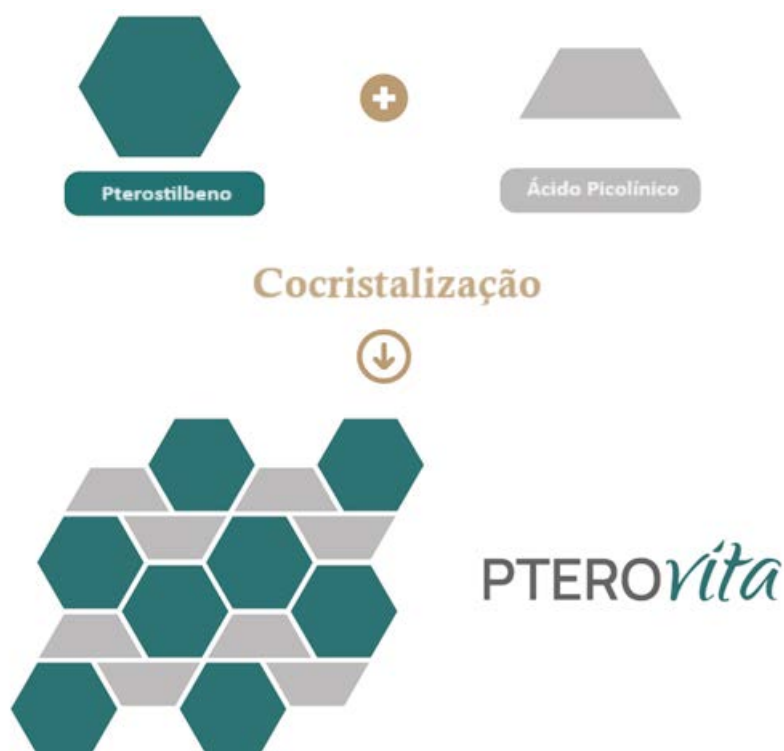
Figura 2. Representação esquemática da cocrystalização entre as moléculas de ácido picolínico e pterostilbene na proporção 1:1.
